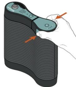
Um den Akku aus dem Steckplatz zu nehmen, drücken Sie auf beide blauen Tasten an den Seiten des Akkus und ziehen Sie den Akku heraus.
