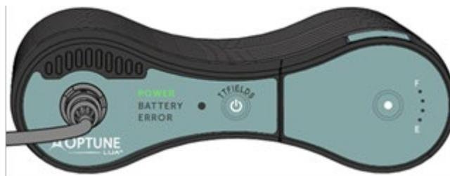
HINWEIS: Wenn ein aufgeladener Akku eingelegt wurde (und kein Netzteil angeschlossen ist), leuchtet die „BATTERY“ (Akku)-Anzeige grün. Falls das Gerät an das Netzteil angeschlossen ist, wird das Gerät über das Netzteil betrieben und die „BATTERY“ (Akku)-Anzeige schaltet sich aus.
